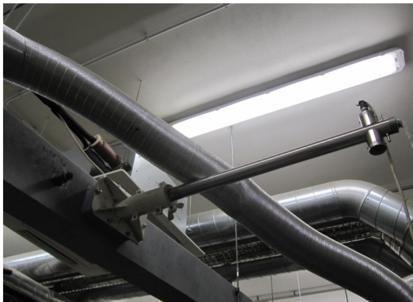
Obrázek 36 Připojení zachycovače 2 k měřicímu profilu na kouřovodu
