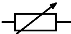
Obrázek 2: Schématická značka potenciometru
