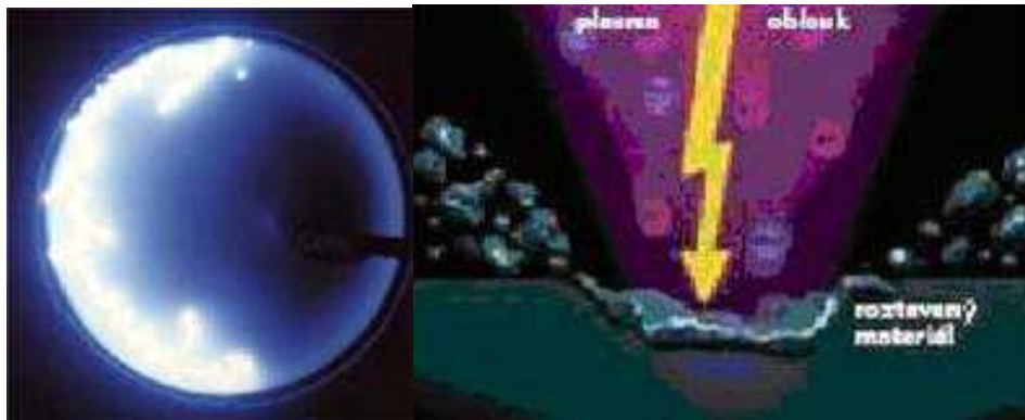
Obr. 2.8 Schéma a pohyb katodové skvrny 4,7,16
