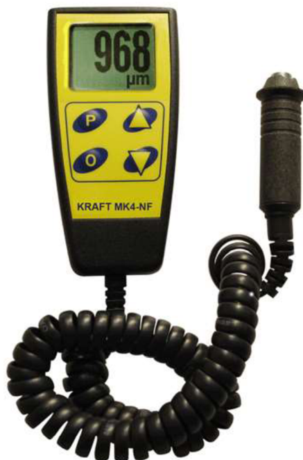
Obr. 4.7 Příklad přístroje k měření tloušťky povrchové vrstvy metodou magneticko-induktivní [8]
