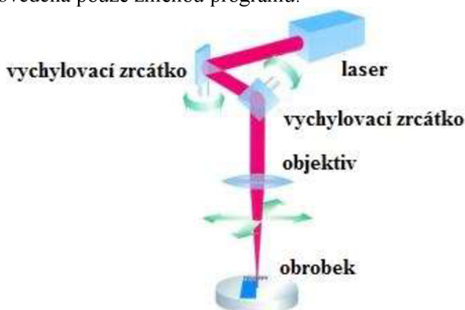
Obr. 2.17 Princip laserového popisování [33]
