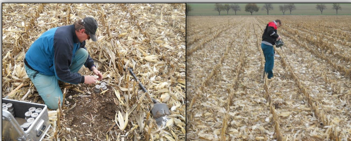
Obr. 14 Odběr Kopeckého fyzikálních váleček (foto: Petr Vrtílek)
