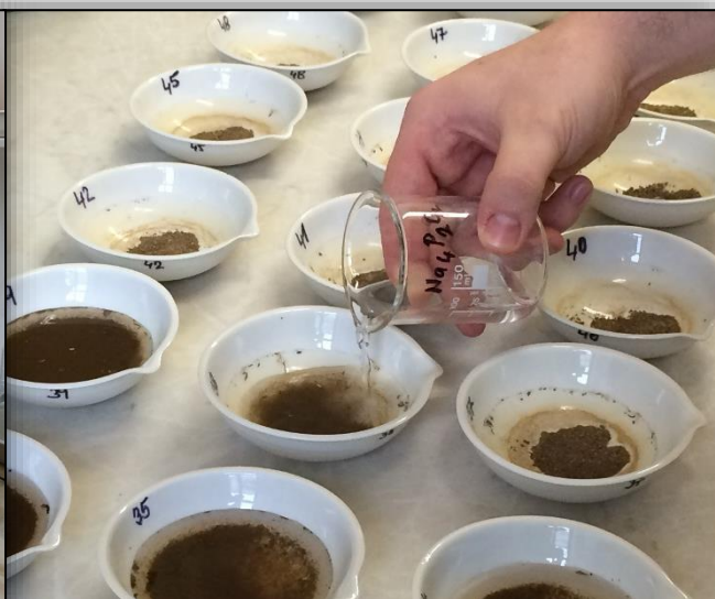
Obr. 19: Zalití půdních vzorků roztokem pyrofosforečnanem sodným (Foto: Milan Novák)
