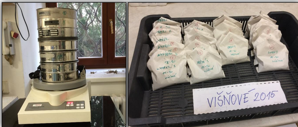
Obr. 16: Stroj síťovací FRITSCH Analysette 3 SPARTAN (Foto: Josef Adámek)
