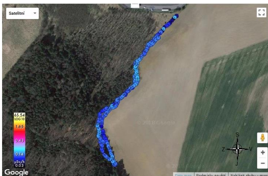
Obr. 29: Měření radiačního mapování lokality Pomezí nad Ohří (SÚRO, 2017)
