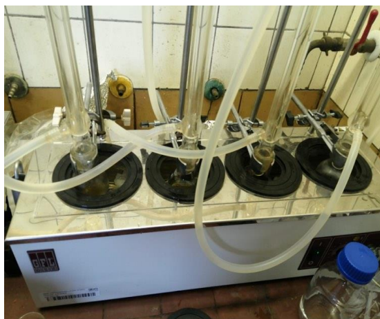
Obrázek 9 - Extrakce pod Liebigovým zpětným chlazením (vlevo) a filtrace vzorků do odměrných (25 ml) baněk (vpravo). Foto autora (2021).
