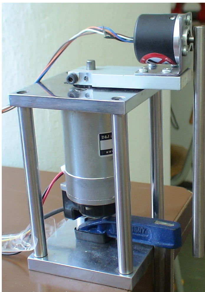
Obr. 4: Sestava rotačního kyvadla
