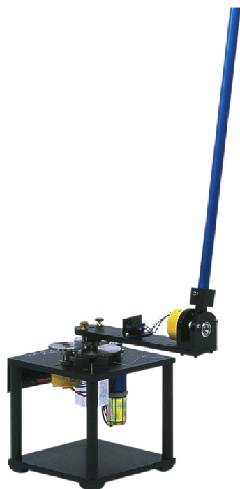
a) DC motor, rameno s těžištěm mimo osu, kyvadlo bez závaží
