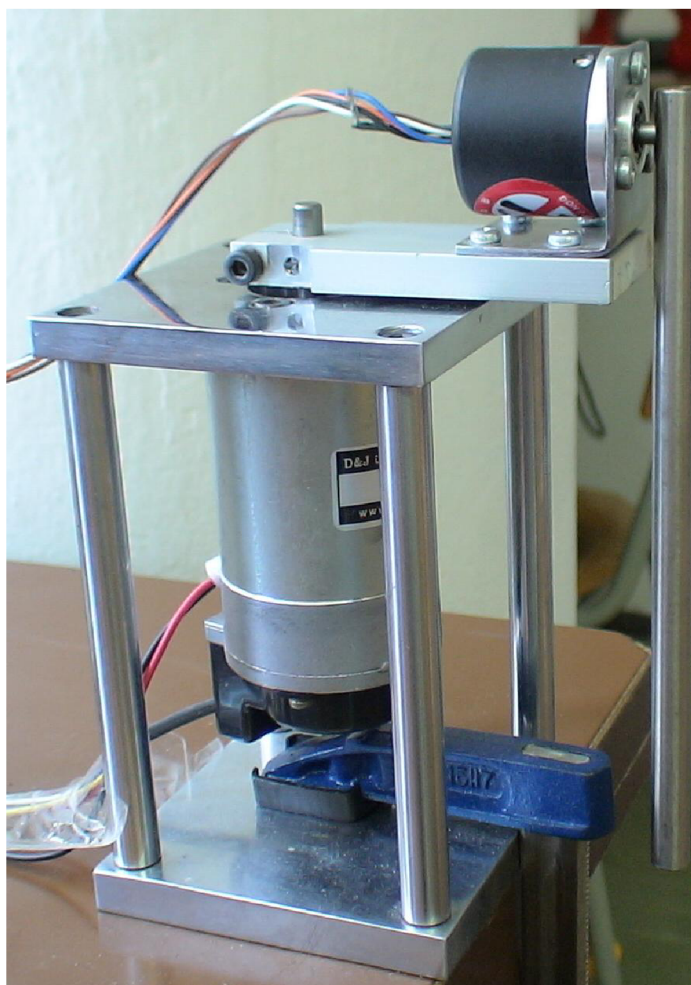
Obr. 4: Sestava rotačního kyvadla
