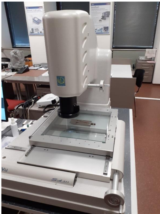
a) Měření na Micro-Vu Sol 311
