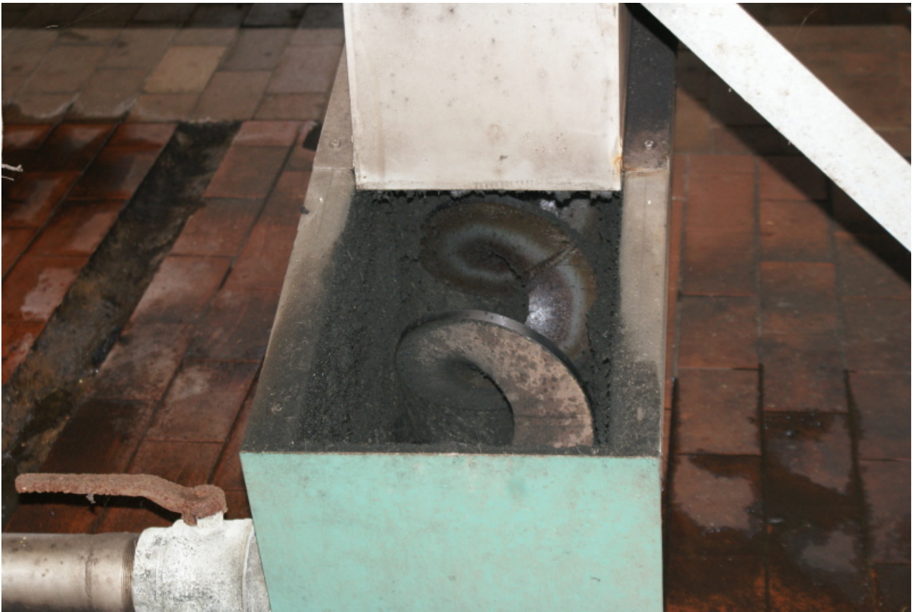
Obr. 36 Šnekový podavač pevné složky ze skladovací nádrže
