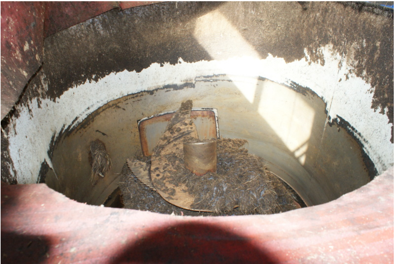
Obr. 9 Rotační šnek na drcení travin v přijmové nádobě
