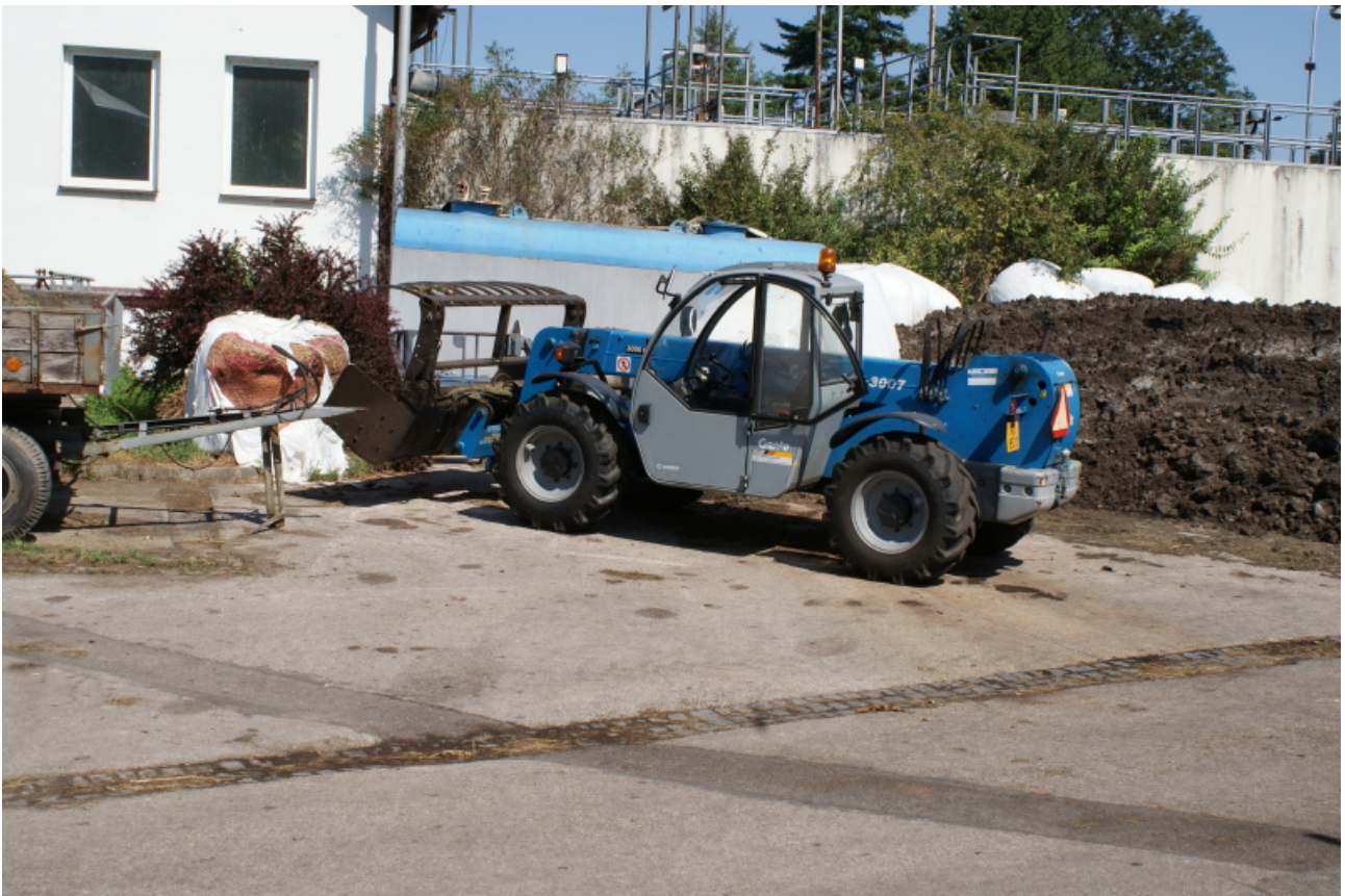
Obr. 6 Manipulátor na dávkování travin do bioplynové stanice
