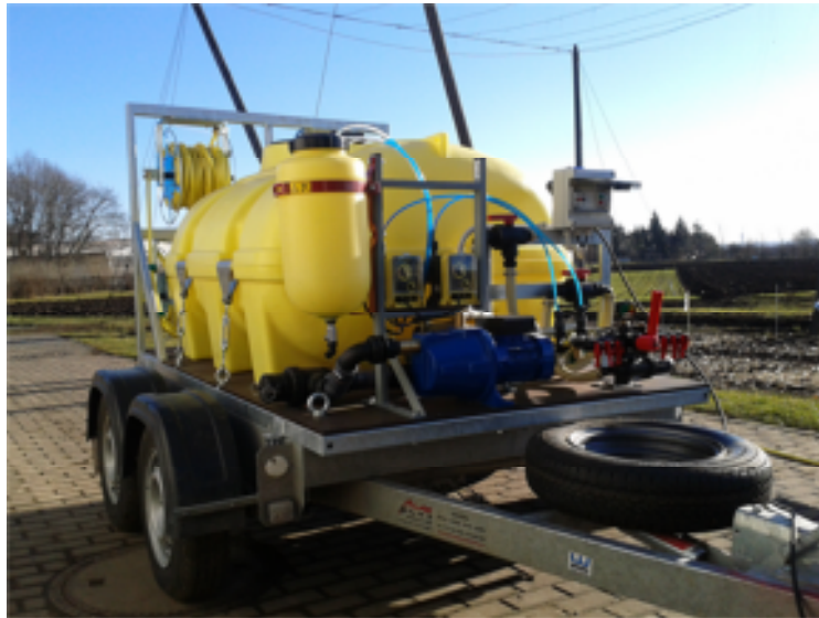
Obr. 14: Dešťový simulátor se zařízením k dávkování barviva (nádoza na levé straně obrázku) [ KZS ČZU Praha]
