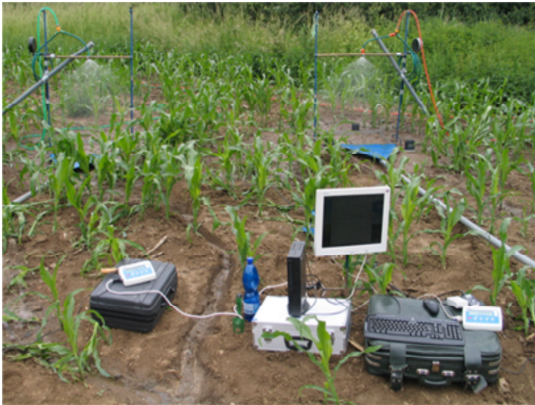
Obr. 13: Měření infiltrace vody do půdy při simulované srážce [simulátor VUZT Praha]
