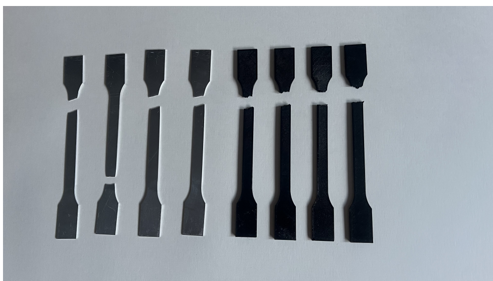
Obr. 5.7: Vzorky po ukončené zkoušce tahem.
