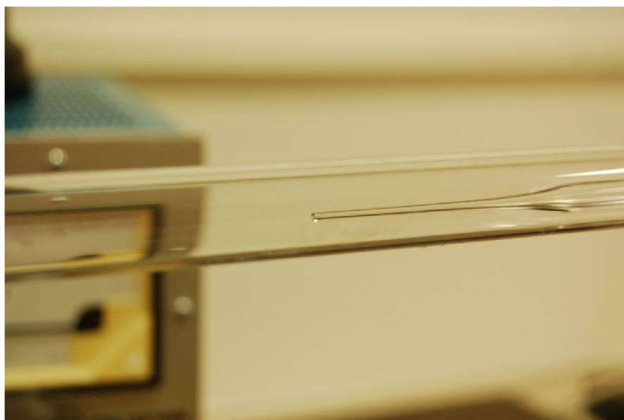
Obrázek č. 13: Fotografie detailu dávkovací titrační aparatury uvnitř výbojové trubice (laboratoř plazmochemie FCH VUT v Brně).
