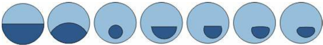
Obr. 6: Možnosti tvaru a umístění segmentu do blízka na bifokální brýlové čočce [17]
