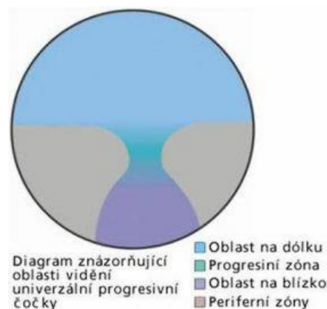
Obr. 8: Diagram znázorňující oblasti vidění univerzální progresivní čočky [19]
