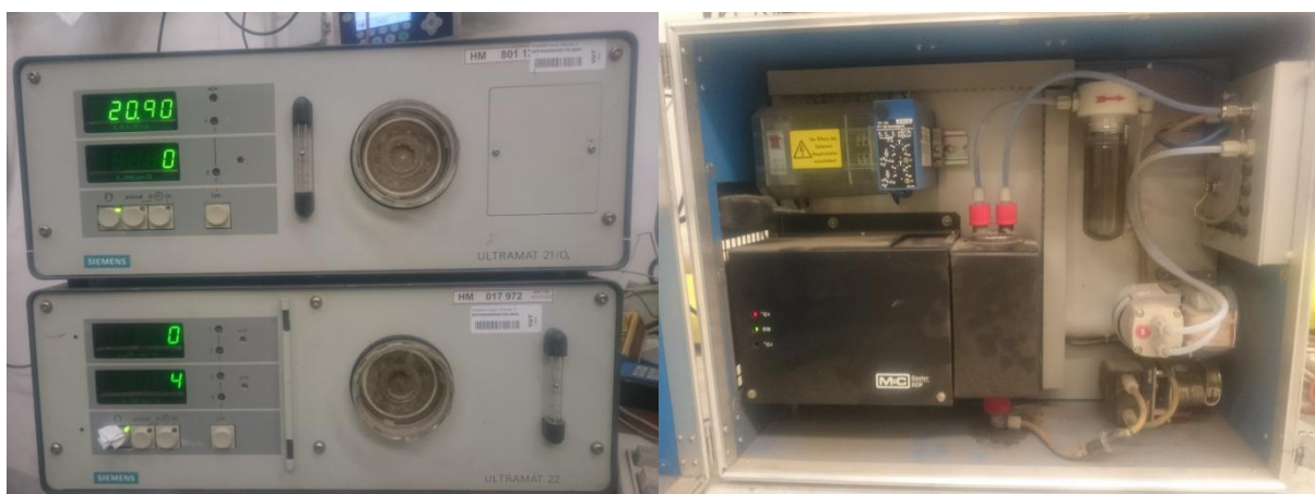
Obrázek 11 ULTRAMAT (vlevo); Zařízení pro úpravu vzorku spalín (vpravo);
