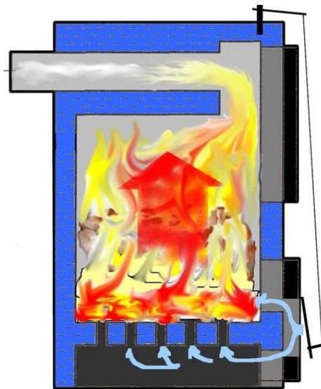
Obrázek 3 Schéma kotle využívající prohořivací technologii [19]
