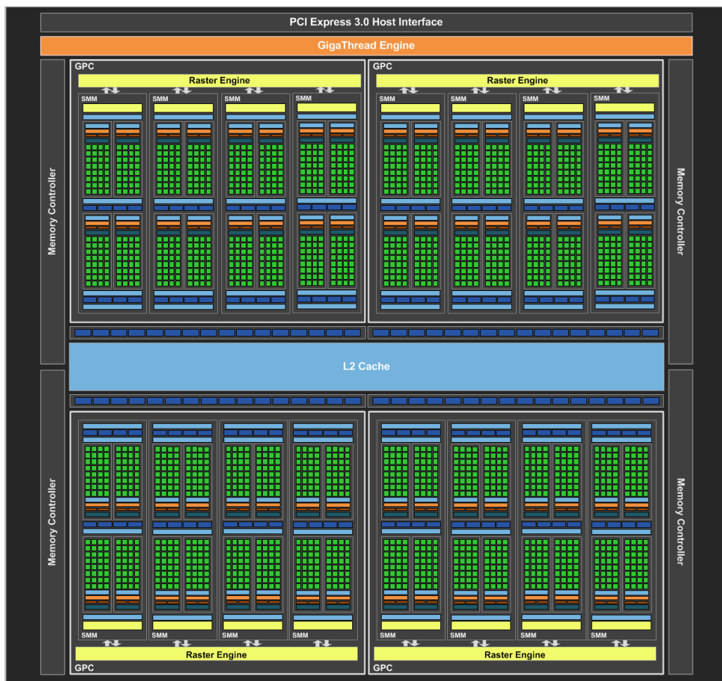
Obrázek 3.1: Architektúra Maxwell v high-end grafickej karte GeForce GTX 980. Obrázok je prebraný z [9]
