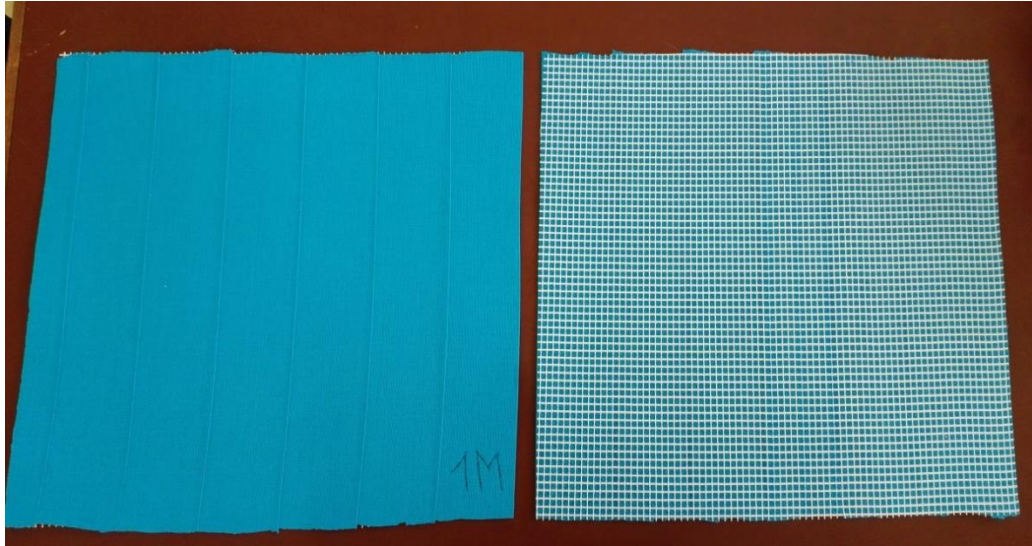
Obrázek 5: VZOREK 2 připravený k měření tepelného a výparného odporu.
