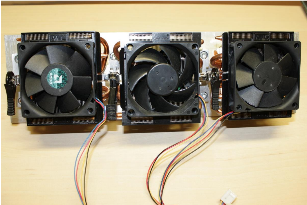
Příloha obr. 3: T-profil jako vodič tepla s osazenými chladiči
