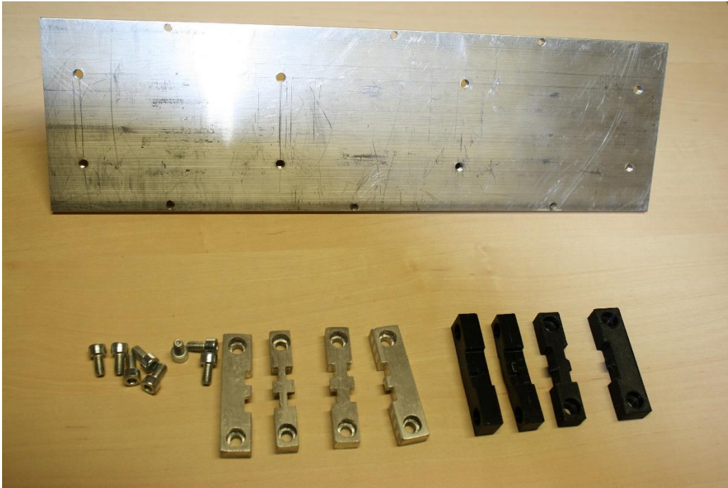
Příloha obr. 1: T-profil jako vodič tepla s montážními prvky pro chladiče z CPU (tištěné a frézované)
