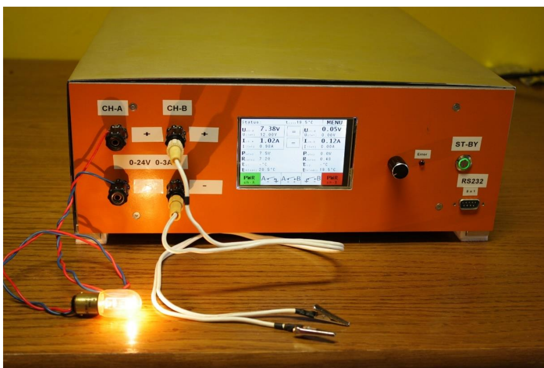
Příloha obr. 10: Záběr zdroje v režimu CC
