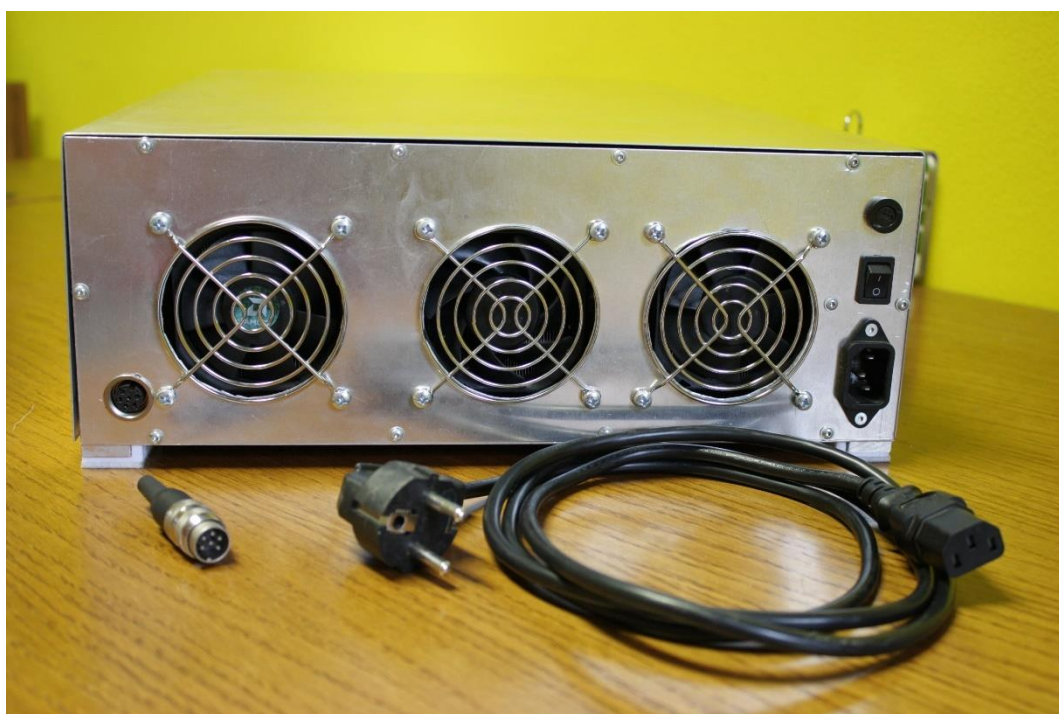
Příloha obr. 8: Detail zadní části zdroje s napájecím kabelem a konektorem pro připojení externích modulů
