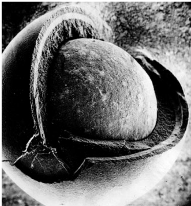
Obrázek 29: Opouzdřený oxid uranu ve vícevrstevném povlaku (pyrouhlík, silikon, pyrouhlík) [43]
