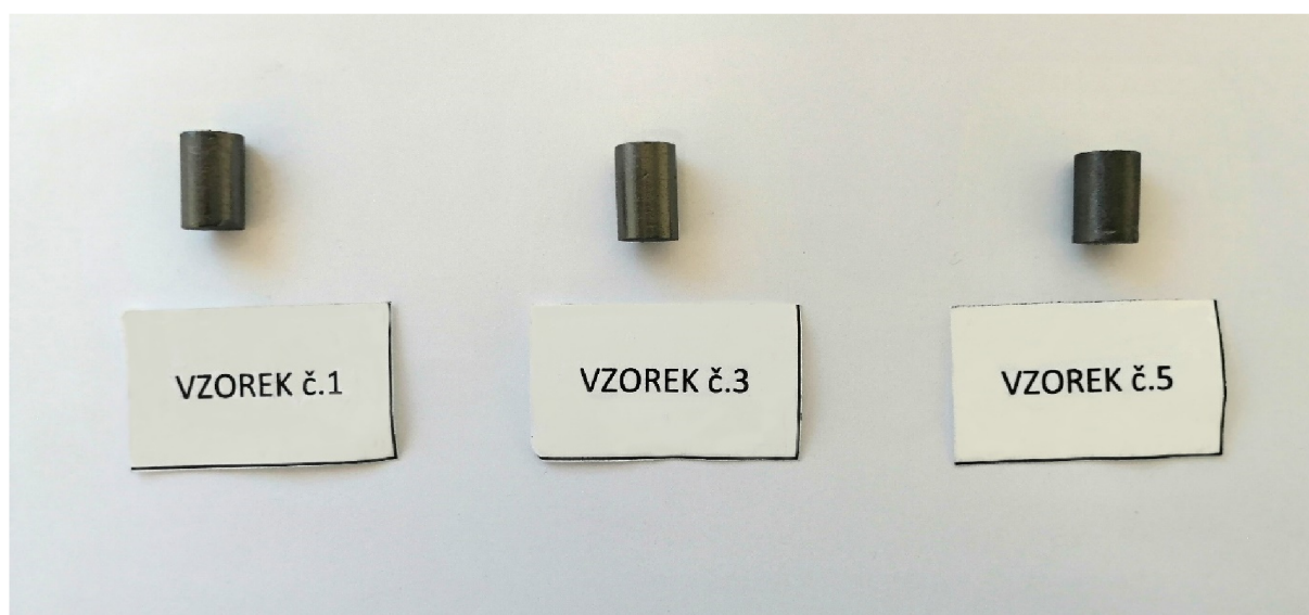
Obrázek 38: Snímek 3 vzorků expandovaného grafitu, připravené pro měření dilatometrie
