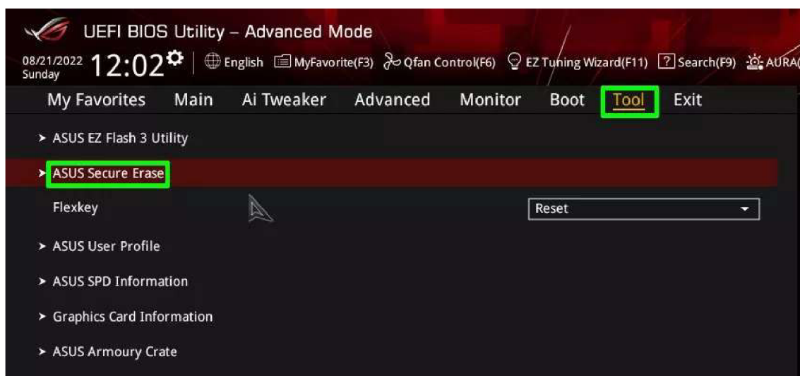
Obrázek 16: Funkce Secure Erase na základních deskách ASUS (převzato z [33])
