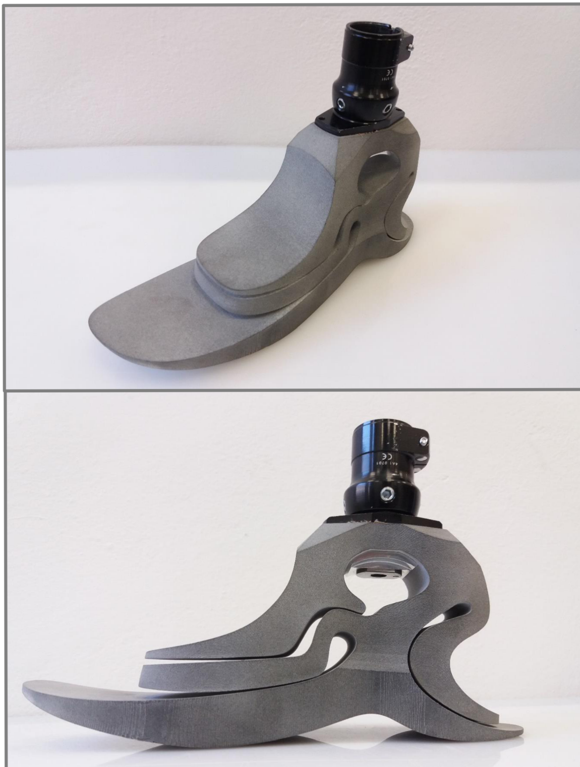
Obr. 4- 21: Fotografie vyrobeného prototypu z materiálu PA12 metodou MJF.
