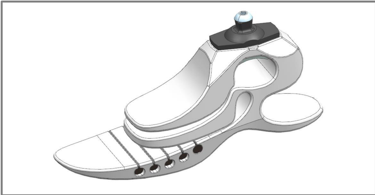
Obr. 4- 7: První navržené chodidlo i s připojovacími adaptéry
