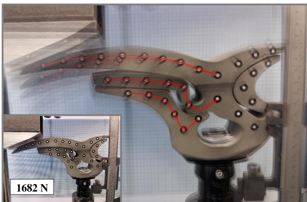
Obr. 4- 26: Zachycení průběhu deformace špice chodidla při statické zkoušce
