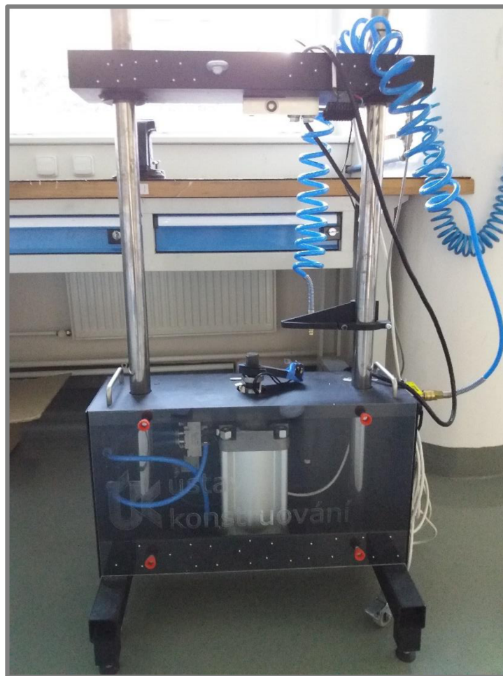
Obr. 4-22: Testovací stand pro zkoušení pahýlových lůžek
