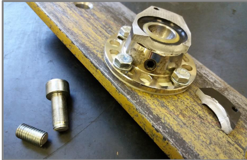
Obr. 4- 29: Díly, jež selhaly v průběhu cyklické zkoušky
