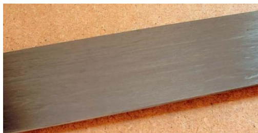
Obrázek 9) FRP výztuž ve formě lamely složená z uhlíkových vláken v epoxidové pryskyřici [16].
