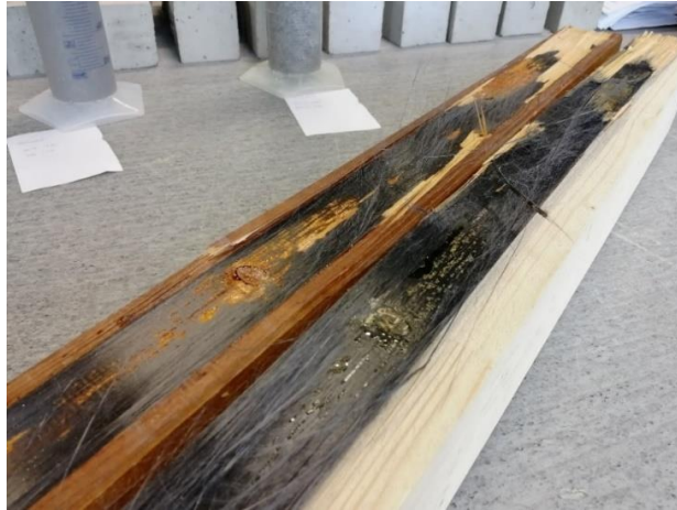
Obrázek 23) Kohezní porušení dřeva (10 %) a CFRP lamely (80 %) spojené epoxidovým lepidlem za působení zvýšené teploty 160 °C.
