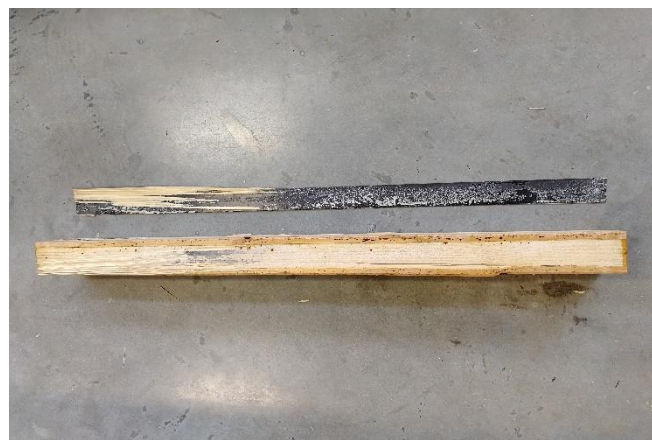
Obrázek 24) Kohezní porušení dřeva (30 %) a CFRP lamely (5 %) spojené polyuretanovým lepidlem při působení teploty 160 °C.
