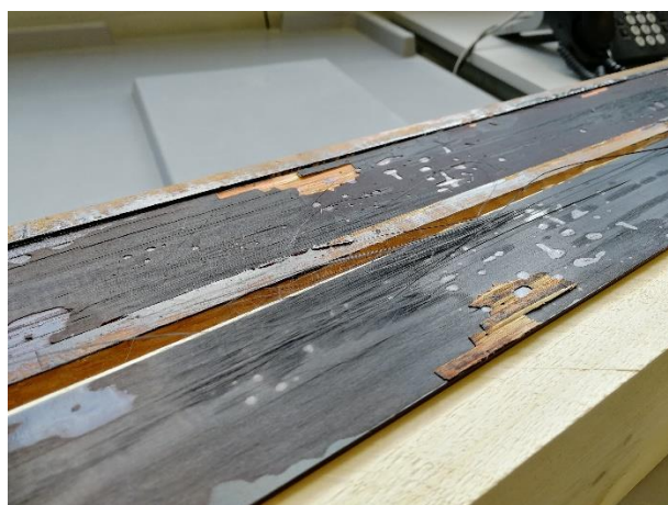
Obrázek 22) Kohezní porušení dřeva (5 %) a CFRP lamely (85 %) spojené fenol–resorcin formaldehydovým lepidlem při působení teploty 160 °C.
