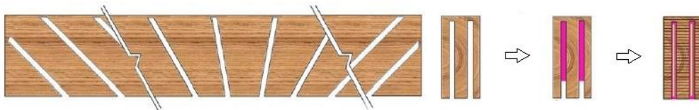
Obrázek 14) Postup vyztužování dřevěného nosníku pomocí FRP prutů [36].
