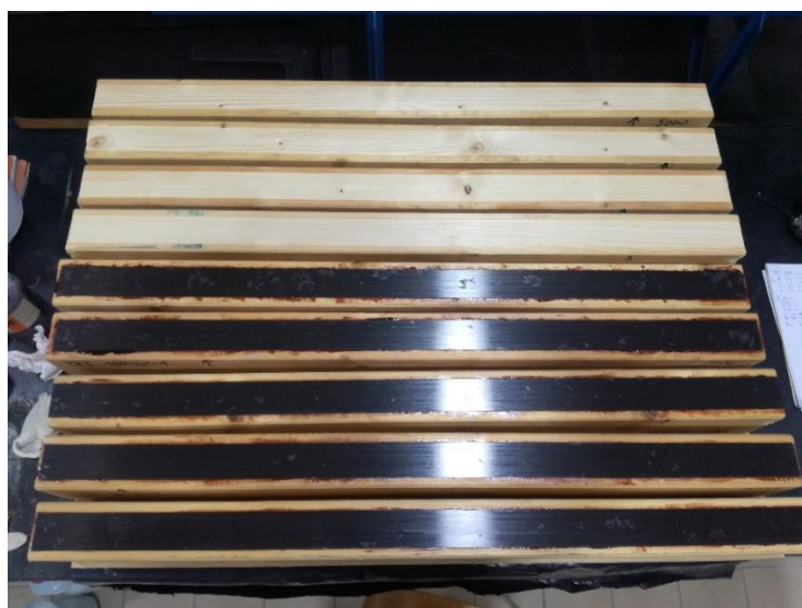
Obrázek 18) Hoblovkou vyřezané drážky v dřevěném trámci spolu s již nalepenou CFRP výztuží.
