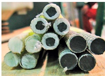
Obrázek 8) FRP výztuž (zleva) – GFRP (výztuž se skleněnými vlákny), C-GFRP (výztuž s uhlíkovými a skleněnými vlákny), CFRP (výztuž s uhlíkovými vlákny) [16].
