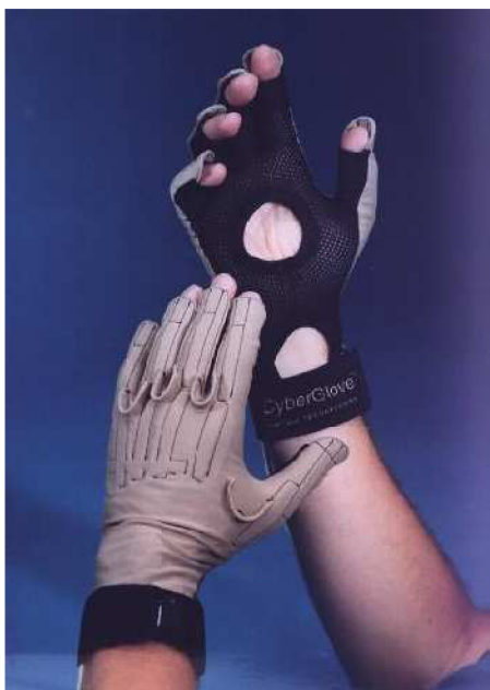
Obrázek 2.2: Rukavice CyberGlove pro přenos informací pro rozpoznání gesta (zdroj [9])
