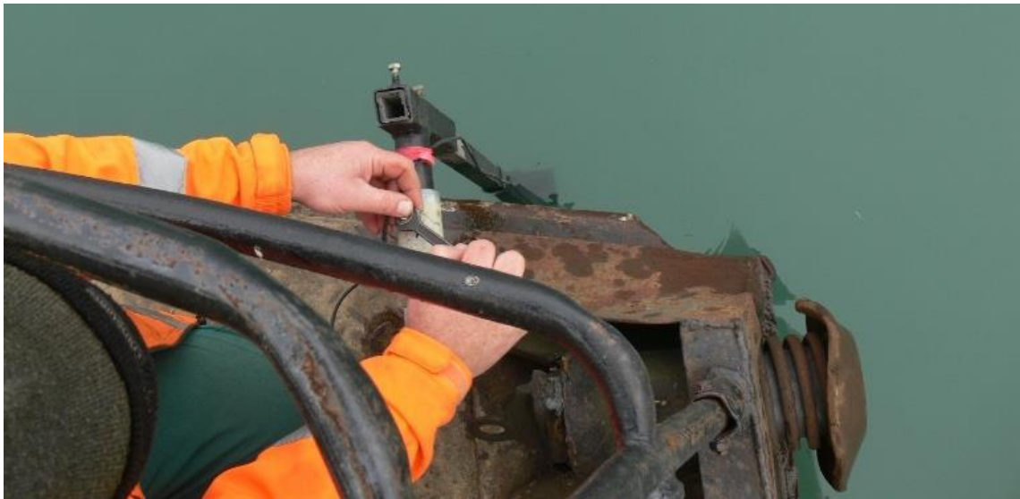
Obr. 35 Osazení echolotu na před' remorkéru [20]
