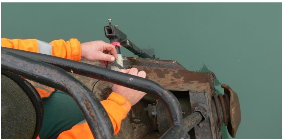
Obr. 35 Osazení echolotu na příď remorkéru [20]
