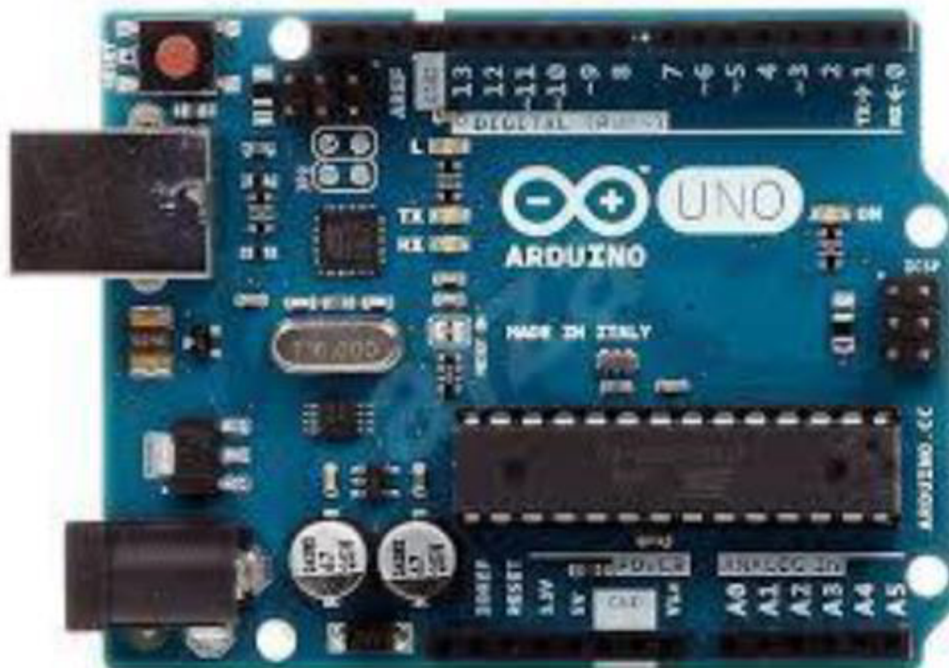
Obr. 12 Řídící jednotka sběru dat kolísání vodní hladiny Arduino UNO Rev3 [19]
