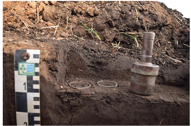
Obrázek 7: Odběr půdních vzorků Kopeckého válečky
