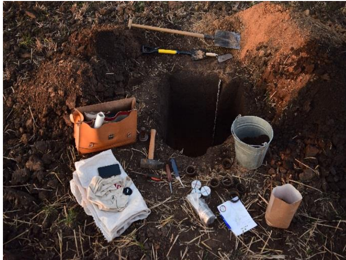
Obrázek 5: Realizace výkopu půdní sondy a odběru vzorků. Na snímku jsou viditelné veškeré použité nástroje při výkopu půdní sondy a odběru půdních vzorků.
