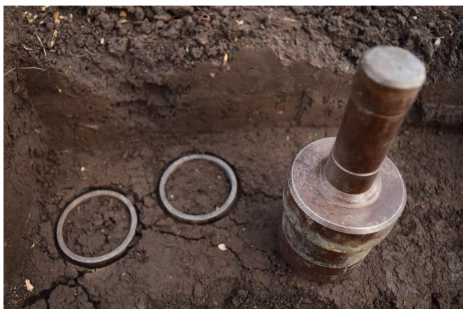
Obrázek 13: Odběr neporušených půdních vzorků Kopeckého válečky
