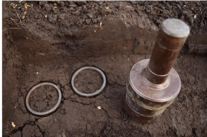
Obrázek 13: Odběr neporušených půdních vzorků Kopeckého válečky
