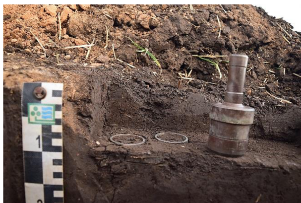
Obrázek 7: Odběr půdních vzorků Kopeckého válečky
