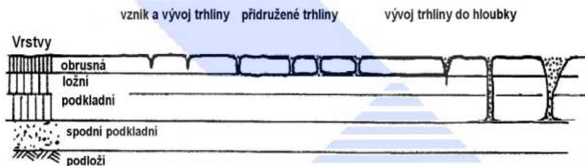
Obr. 21 Znárodnění vzniku a vývoje trhlin [25]
