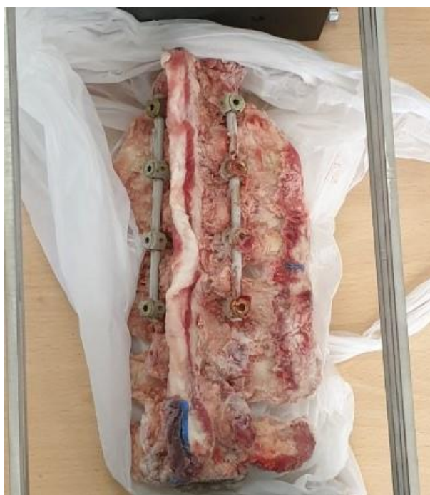
Obr. 4: Vepřová páteř s fixátory použitá v experimentu
