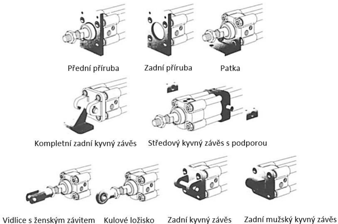
Obr. 23) Příklady upevnění pro PV dle ISO 15552 [16]
