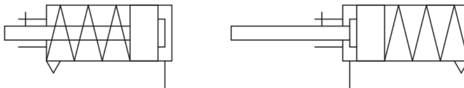
Obr. 5) Schématické značky jednočinných válců. a) pružina zasouvá pístnici b) pružina vysouvá pístnici [33]
