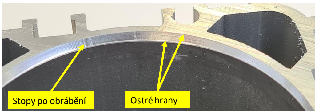
Obr. 41) Ostrá náběhová hrana a stopy po obrábění
