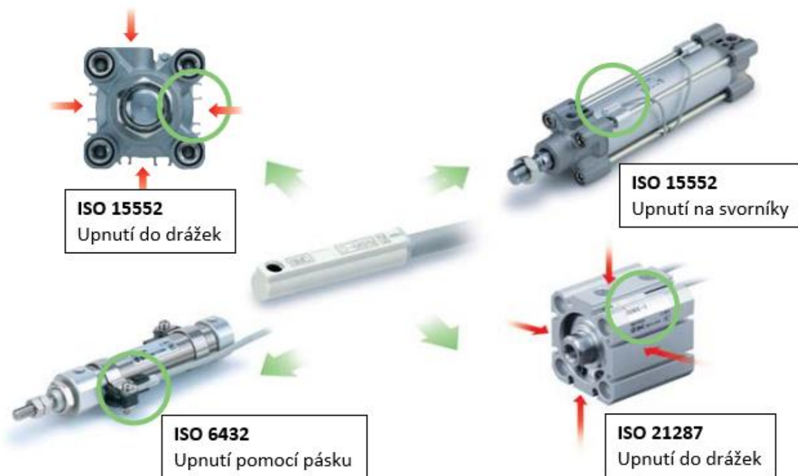
Obr. 24) Způsoby upnutí snímačů polohy u PV dle ISO norem [33]
