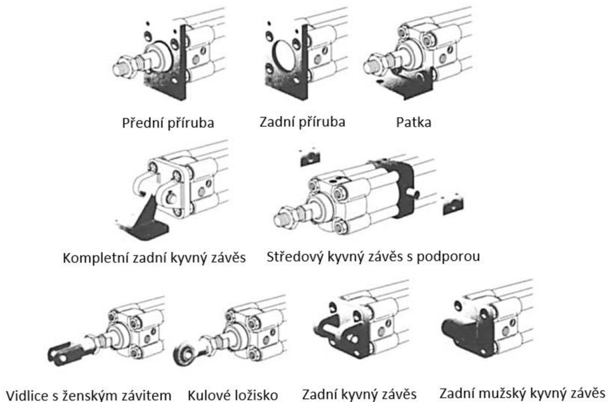
Obr. 23) Příklady upevnění pro PV dle ISO 15552 [16]
