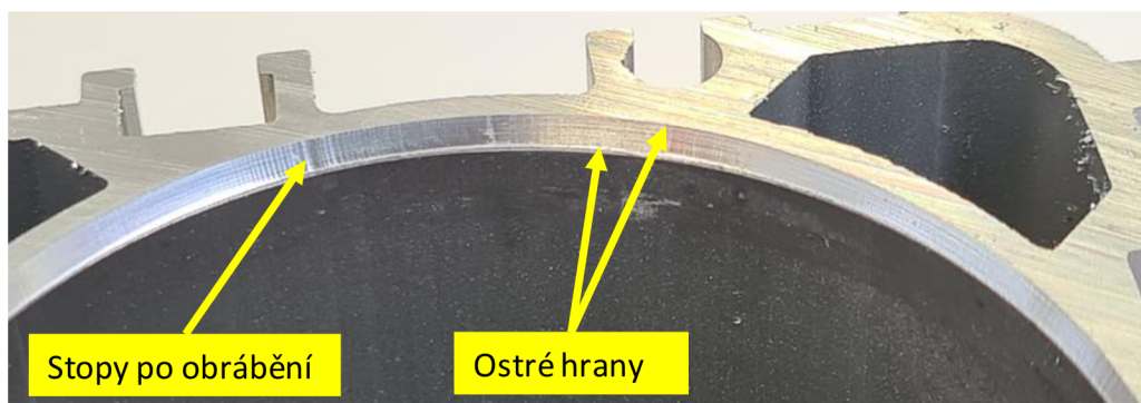
Obr. 41) Ostrá náběhová hrana a stopy po obrábění
