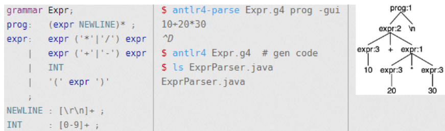
Obr. 3.3: Ukážka práce s ANTLR. Popis z ľavej strany: V prvej časti obrázka je zadefinovaná gramatika uložená v súbore. V strede je volanie antlr-parse príkazu na výraz 10 + 20 * 30 . Napravo vidíme výstup príkazu [11]
