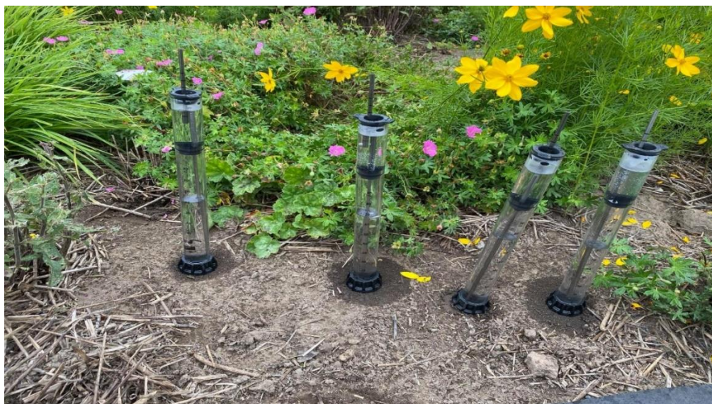
Obrázek 9 Měření infiltrace pomocí Mini Disk infiltrometrů.
