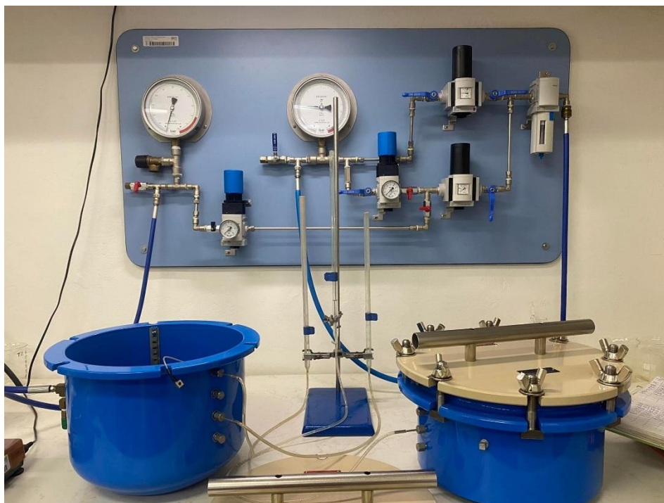
Obrázek 8 Přetlakový aparát pro stanovení retenční čáry půdní vlhkosti.
