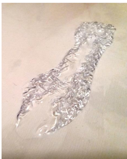
Obr. 10 reakce lepidla na PVC plast
