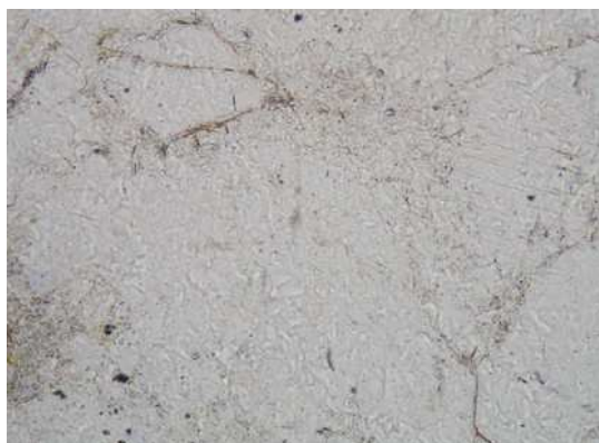
Obr. 24. Mikroklin, myrmekit, PPL, šířka snímku 1mm
