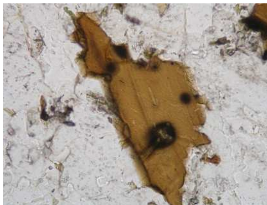
Obr.34. Pleochroické dvůrky v biotitu, PPL, šířka snímku 0,5mm
