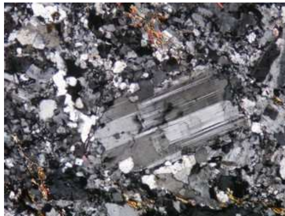
Obr.23. Vyroستlice plagioklasu, XPL, šířka snímku 2mm
