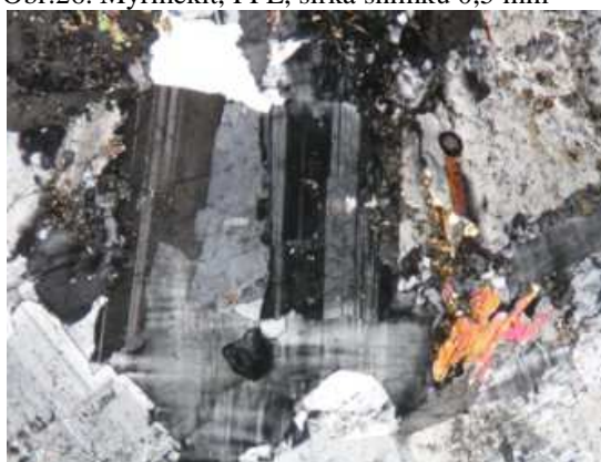
Obr.28.Plagioklas, mikroklin, XPL, šířka snímku 1 mm
