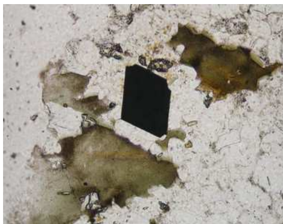
Obr. 42. Magnetit, PPL, šířka snímku 0,5mm
