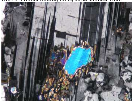
Obr. 39. Plagioklas, muskovit, XPL, šířka snímku 0,2mm
