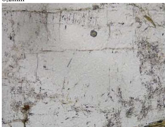
Obr. 38. Plagioklas, muskovit, PPL, šířka snímku 0,2mm
