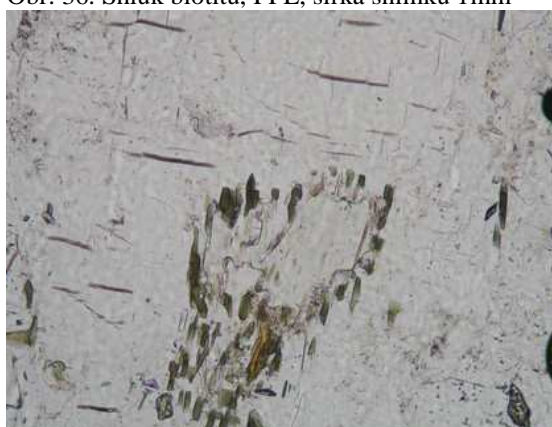
Obr. 38. Plagioklas, muskovit, PPL, šířka snímku 0,2mm
