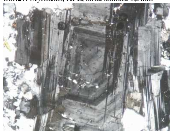
Obr.29. Zonální plagioklas, šířka snímku 0,5 mm
