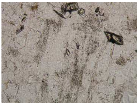
Obr.18. Titanit, PPL, šířka snímku 0,5mm
