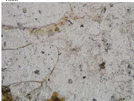
Obr. 24. Mikroklin, myrmekit, PPL, šířka snímku 1mm
