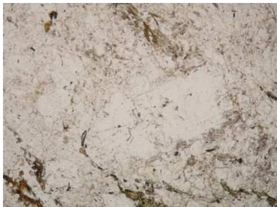
Obr.22. Vyroستlice plagioklasu, PPL, šířka snímku 2mm
