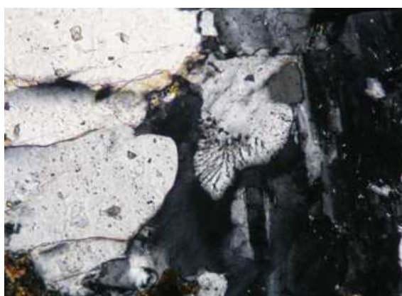
Obr. 25. Mikroklin, myrmekit, XPL, šířka snímku 1mm
