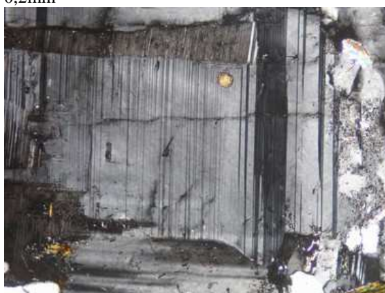
Obr. 39. Plagioklas, muskovit, XPL, šířka snímku 0,2mm
