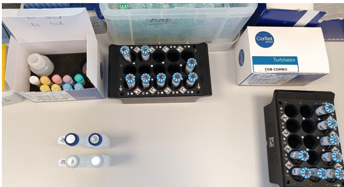
Obr. 6: Nově testované reagenční sady FOB Turbilatex® Combo (vpravo nahoře) a FOB-Test Turbo (vlevo nahoře) spolu s oštitkovánými zkumavkami připravenými k pipetování příslušných kalibrátorů a kontrolních vzorků. Dále pak reagenční nádobky Empty 1 a 2 (vlevo dole) připravené k pipetování reagií R1 a R2. Foto: Pavla Mošnerová.
