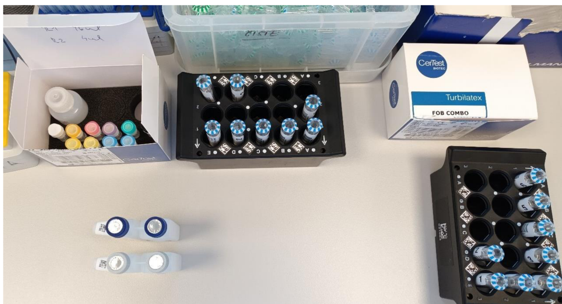
Obr. 6: Nově testované reagenční sady FOB Turbilatex ® Combo (vpravo nahoře) a FOB-Test Turbo (vlevo nahoře) spolu s oštitkovánými zkumavkami připravenými k pipetování příslušných kalibrátorů a kontrolních vzorků. Dále pak reagenční nádobky Empty 1 a 2 (vlevo dole) připravené k pipetování reagensů R1 a R2. Foto: Pavla Mošnerová.
