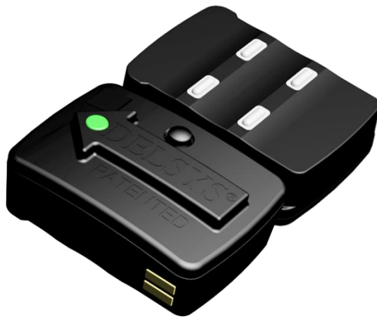
Obrázok 9. Akcelerometer Tringo™ IM. (Anonymous, 2018).
