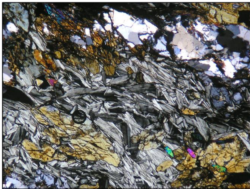
Obr. 32. Šupinky chloritu šedé interferenční barvy a zrna amfibolu v křemen-magnetitové rudě. Vzorek KOS-ŠP-23. Leštěný výbrus, XPL. Šířka snímku 2 mm.
