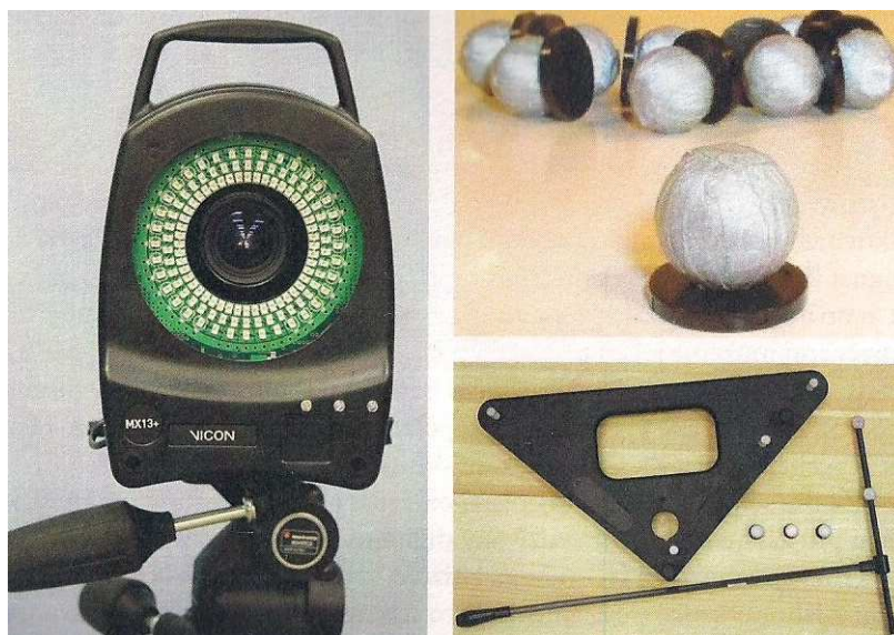
Obrázek 11. Kamera Vicon MX, reflexní značky a kalibrační zařízení (Janura et al., 2012)
