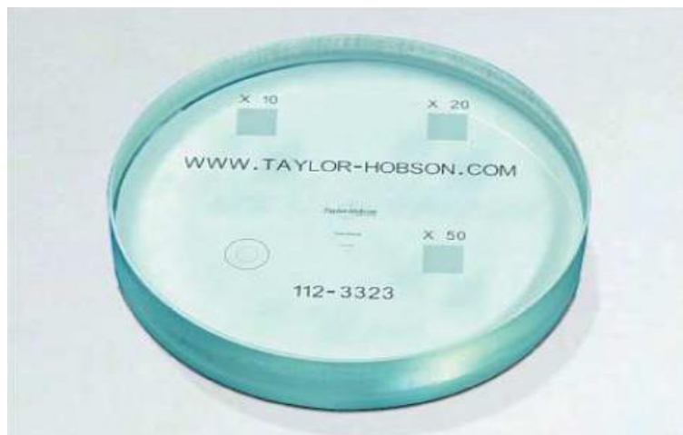
Obrázek 3.2 Etalon pro příčnou kalibraci všech objektivů [31]
