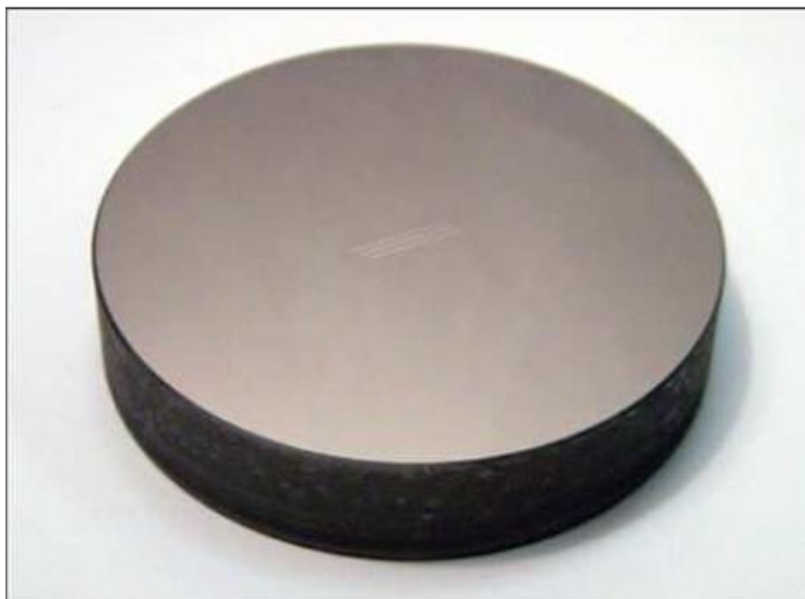
Obrázek 3.1 Kalibrační etalon 5 \mu m výšky stupně [31]
