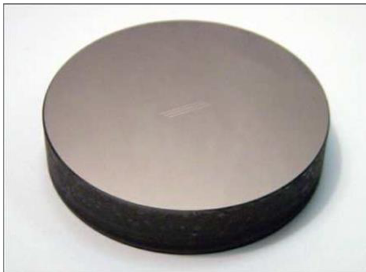
Obrázek 3.1 Kalibrační etalon 5 \mu m výšky stupně [31]
