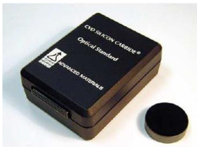
Obrázek 3.3 Kalibrační ploché zrcadlo 0,2nm RMS [31]
