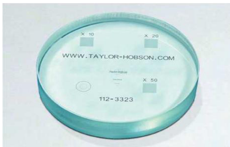
Obrázek 3.2 Etalon pro příčnou kalibraci všech objektivů [31]
