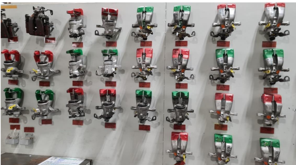
Obr. 7 Etalony – kalibrované vzorové vadné a dobré brzdy Zdroj: vlastní zpracování
