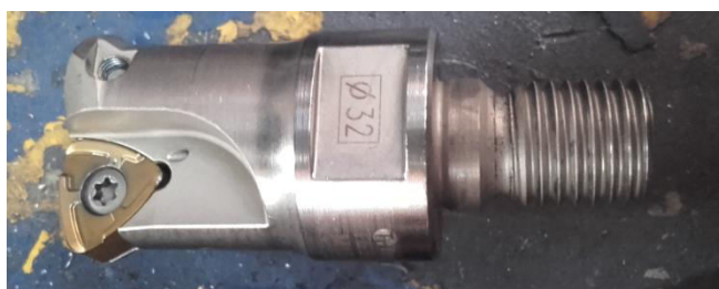
Obr. 6.23 Šroubovací fréza o průměru 32 mm.
