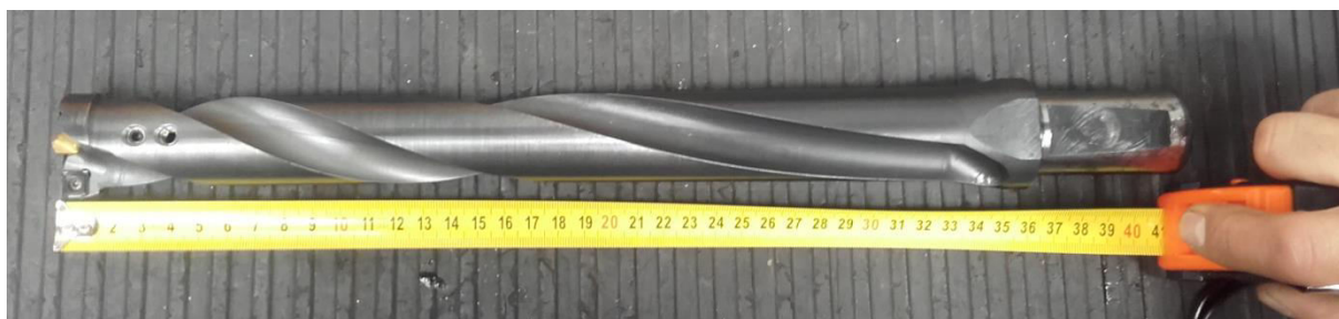
Obr. 6.14 Vrtáky s vyměnitelnými břitovými destičkami.
