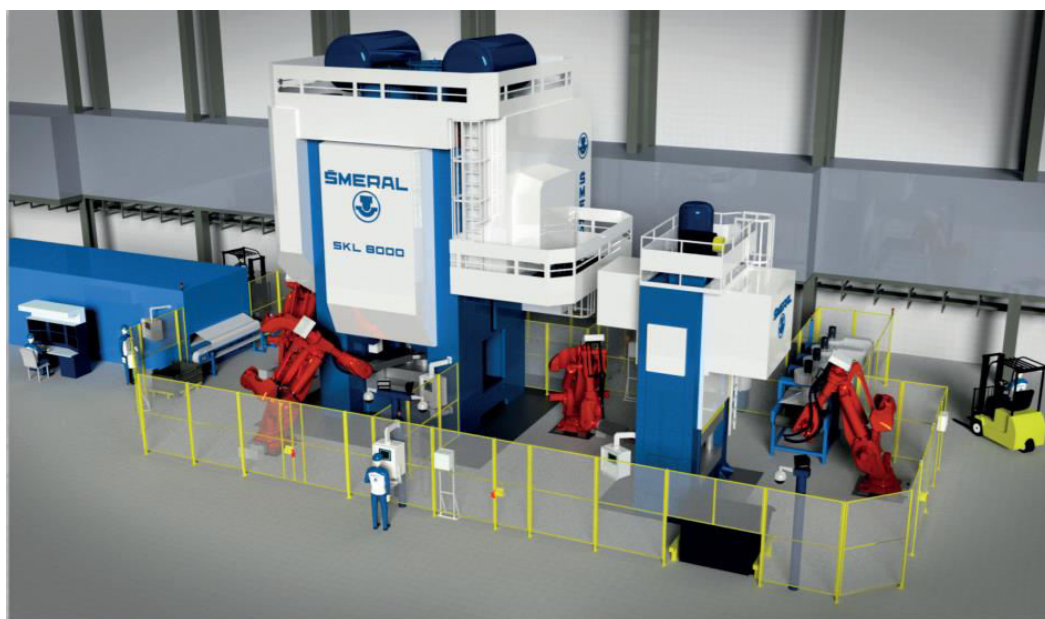
Obr. 1.1 Automatizovaná tvářecí linka se svislým kovacím lisem a ostříhovacím lisem [4].
