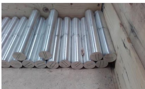
Obr. 4.1 Přířezy z kruhové tyče.
