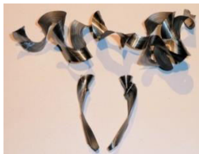
Obr. 6.18 Nevhodný tvar třísek [57].
