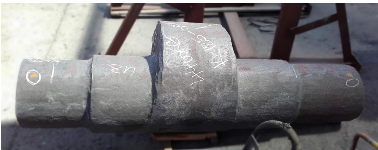
Obr. 1.5 Kovaný polotovary výstředníkové hřídele.
