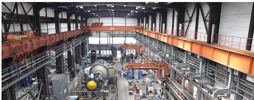
Obr. 5.1 Podstropní mostový jeřáb [4].
