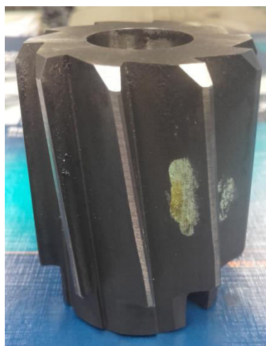
Obr. 6.26 Nástrčný výstružník se zuby ve šroubovici.
