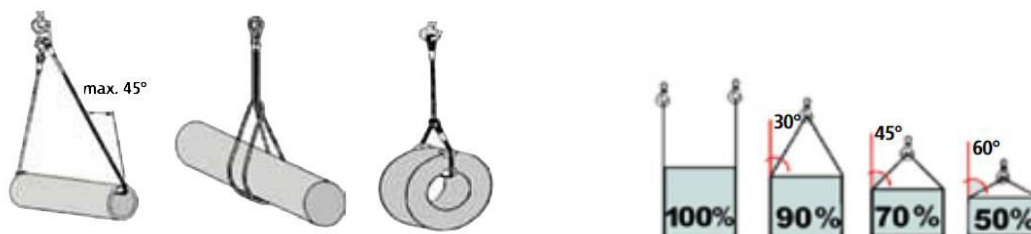
Obr. 5.2 Příklady vázání břemen rotačního tvaru [48] Obr. 5.3 Uspořádání vázacích prostředků [48].
