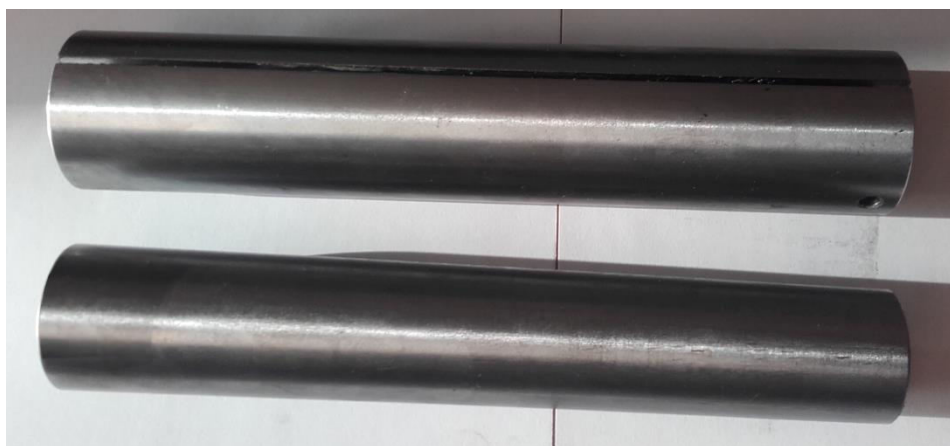
Obr. 4.20 Vyrobené rozpěrné pouzdro a kuželový kolík
