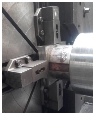
Obr. 5.10 Upnutí na soustruhu za pomocnou přírubu.
