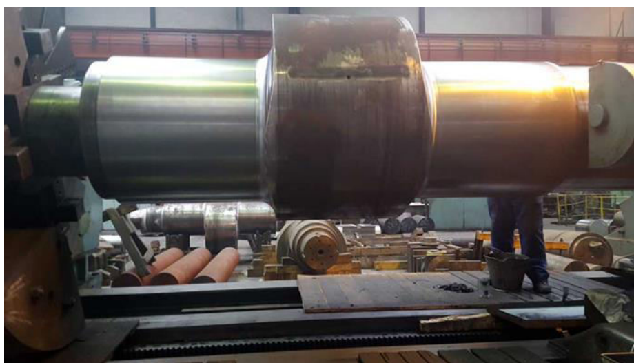
Obr. 5.13 Upnutí výstředníkové hřídele na soustruhu.
