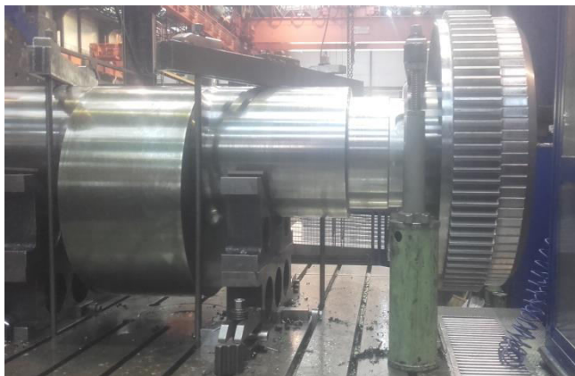
Obr. 6.7 Upnutí na pracovní stůl.
