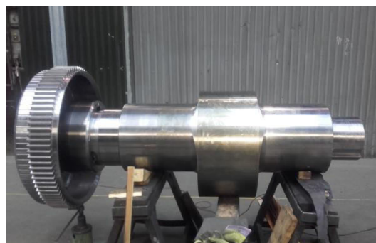
Obr. 6.1 Ustavení ořechu spojky.
