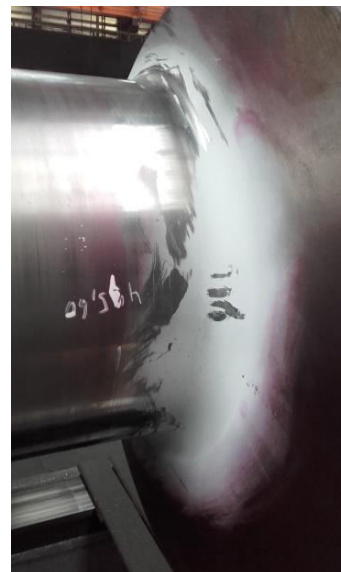
Obr. 5.16 Penetrační zkouška na trhliny.
