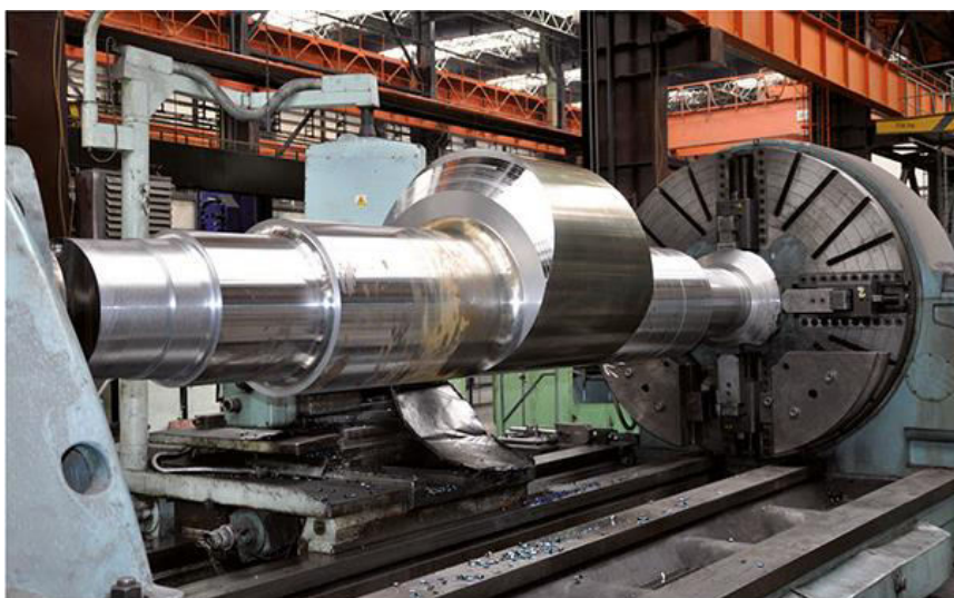
Obr. 1.6 Soustružení výstředníkové hřídele.
