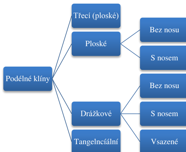
Obr. 2.2 Rozdělení podélných klínů.
