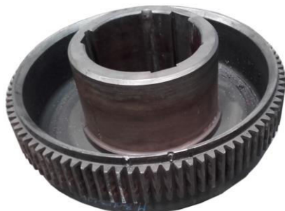
Obr. 1.14 Demontovaný ořech spojky.
