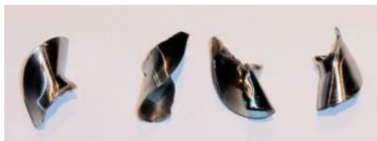
Obr. 6.17 Správný tvar třísek [57].
