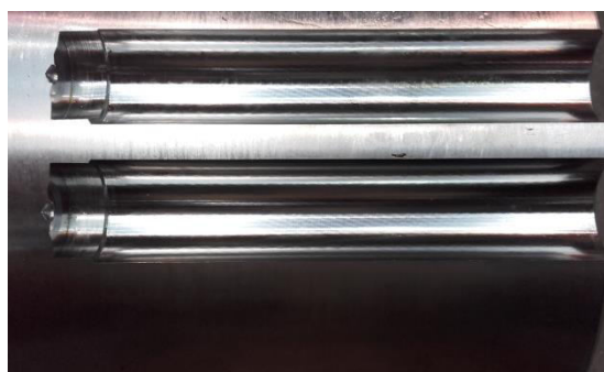
Obr. 6.28 Ukázka obrobeneých děr po demontáži
