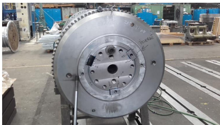
Obr. 2.17 Demontáž podélného klínu.
