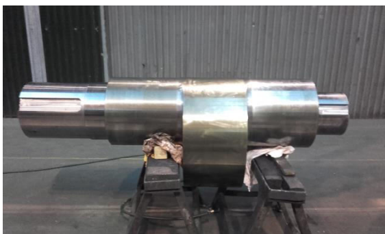
Obr. 6 Uložená výstředníková hřídel.
