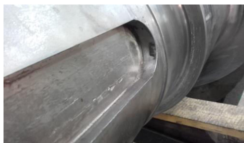
Obr. 3.8 Stav drážky po demontáži klínu.
