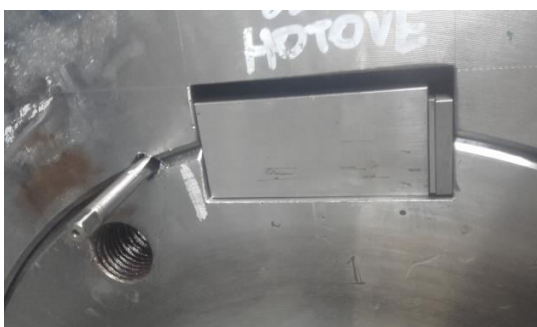
Obr. 6.2 Pojištění a vymezení poloh drážek.
