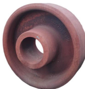
Obr. 1.11 Výchozí polotovar ořechu spojky.
