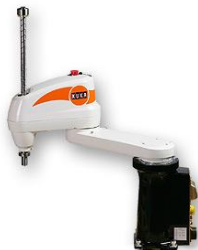
Obr. 8 Průmyslový robot KR 5 SCARA R350 [6]
