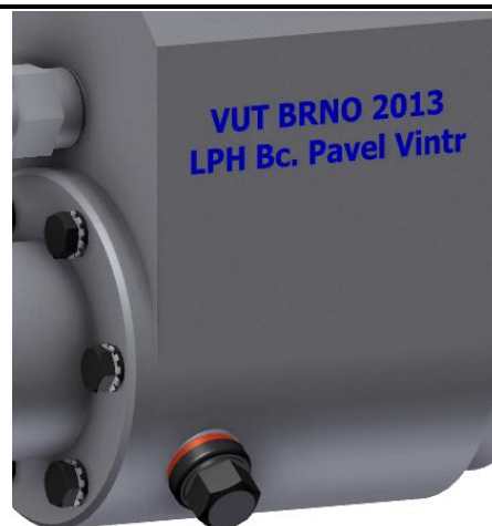
Obr. 63 Odvzdušňovací šroub č. 2
