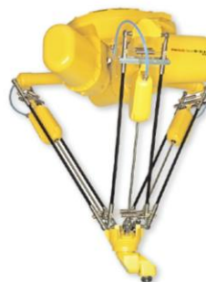
Obr. 9 Průmyslový robot Fanuc M-3iA [7]
