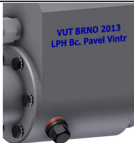
Obr. 63 Odvzdušňovací šroub č. 2
