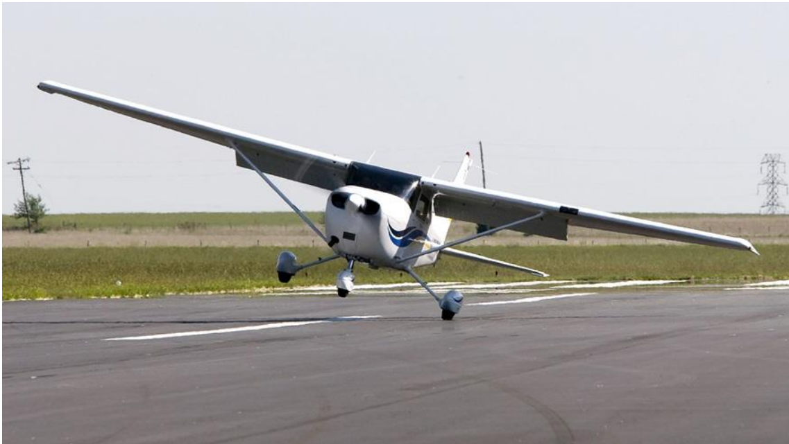
Obr. 1.4 Přistání letounu Cessna 172 při silném bočním větru
