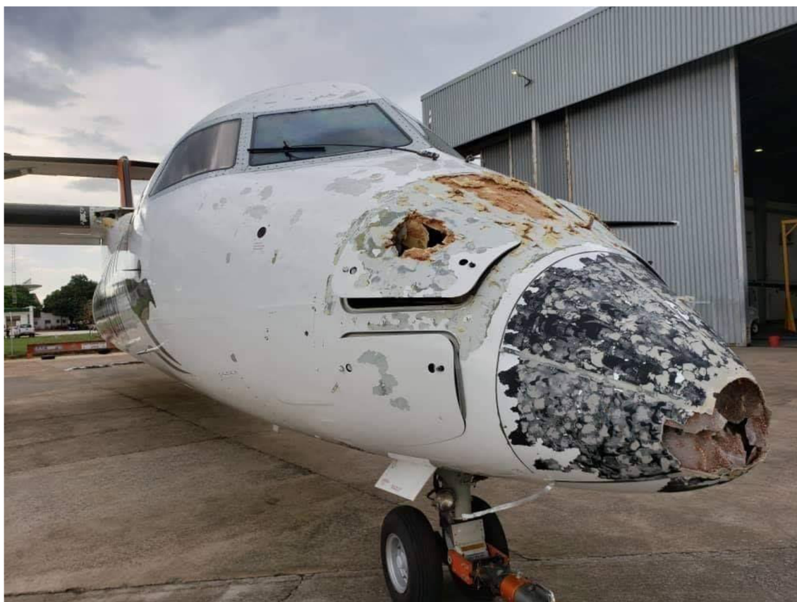
Obr. 1.8 Letoun DHC-8-300 po průletu oblastí s kroupami
